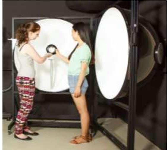
Ulbrich Kugel- Messung des Lichtstroms einer Leuchte
